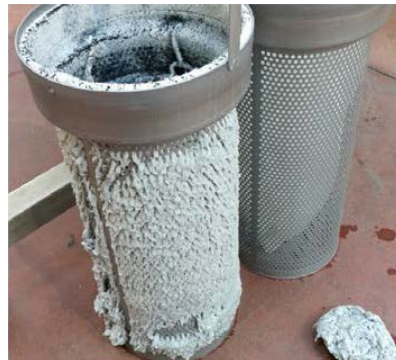
易于清理、更换滤芯的过滤装置
