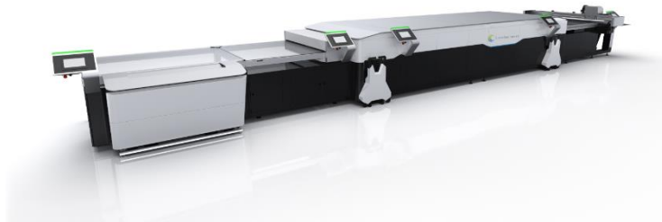
Bildunterschrift: CrystalCleanConnect – die weltweit erste, von Asahi Photoproducts und ESKO gemeinsam entwickelte vollautomatische Lösung zur Herstellung von Flexodruckplatten
